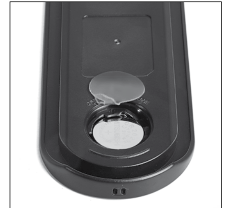
Fig. 2 Retirer la languette en plastique et remettre la pile correctement.
