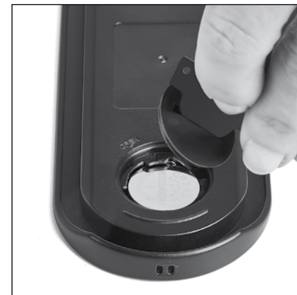
Fig. 3 Fermer hermétiquement le couvercle, tourner dans le sens horaire à la position FERMÉ.
