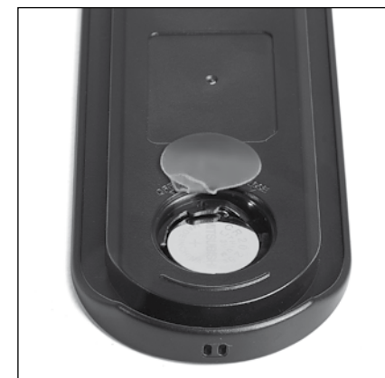
Fig. 2 Rimuovere la linguetta in plastica e riposizionare correttamente la batteria.
