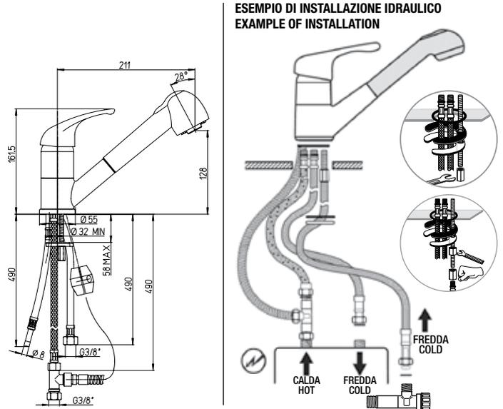
ESEMPIO DI INSTALLAZIONE IDRAULICA
